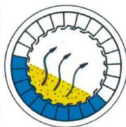
Secador resfriador rotativo com fendas de ar internas. Rotary cooler dryer with internal air slots.
