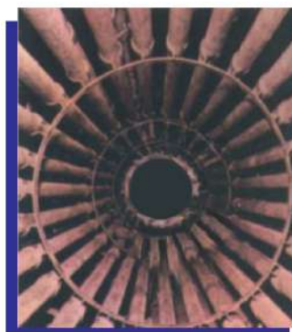
Secador tostador com tubos internos aquecidos para farelos. Toasting dryer with heated internal tubes for brans.
