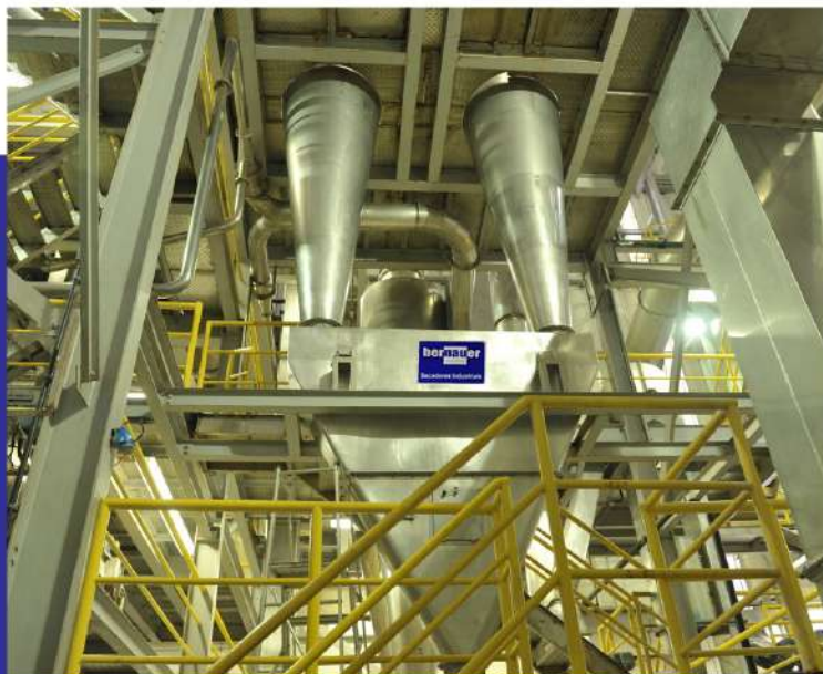
Secador e resfriador de coluna, com aquecimento a vapor, água quente ou gás. Flash dryer and cooler column with steam heating, hot water or gas.
